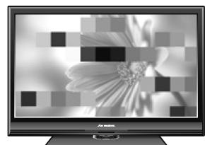
**●対策** テレビ・レコーダーやチューナーに入力する地デジの信号のレベルが低い場合は、高性能タイプのUHFアンテナに取り換えたり、ブースターを取り付けてください。また、コネクター やケーブルなどの接続部への外来電波混入の場合は、シールド効果の高いデジタル放送対応機器に取り換えてください。ただし、アンテナ受信時に発生している場合は、発生側を対策する必要があります。
