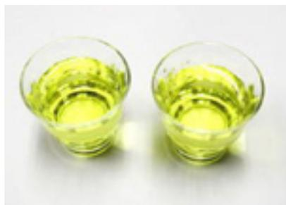
水道水に試薬1滴で黄色く残留塩素反応した実験
