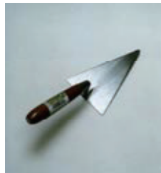
ブロックゴテ ブロックにモルタルを塗る時に使います。
