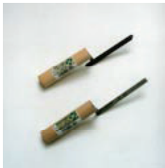
目地ゴテ レンガ・タイルの目地など細かい部分を塗ります。
