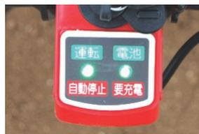
運転ランプ、電池ランプ共に、緑点灯時が運転可能な状態です。運転ランプが赤点灯時は要点検、電池ランプが赤点灯時は充電が必要な場合です。
