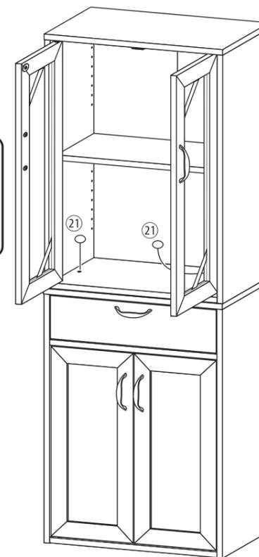
4 ⑭ハネ付ダボを取り付けてから、④移動棚(×2)を取り付けて完成です。
