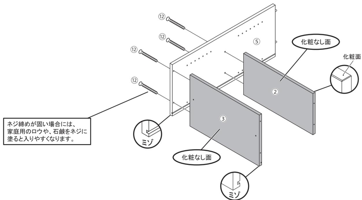
**3** ⑥右側板を⑫組み立てネジで取り付けます。(＋ドライバー使用)
