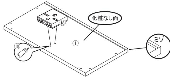
**6** ①天板のダボ穴に⑩接着剤を入れ、**4**で組み立てたものに①天板を取り付けます。(古雑誌、ゴムハンマー使用)
