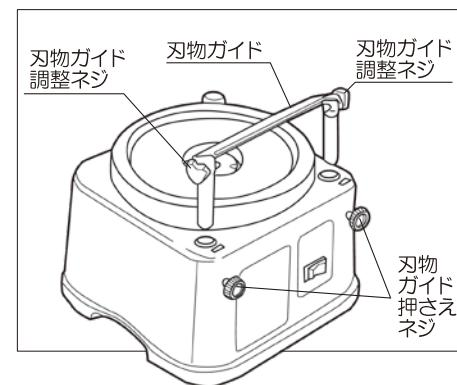
図 刃物ガイドと砥石の間隔は1~3mmが適当です。刃物に合わせて調整してください。
