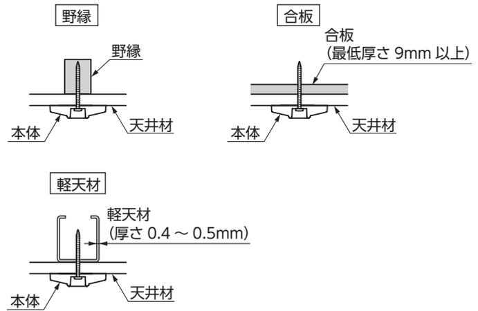
ネジが空回りしやすいので、注意してネジ締めしてください。
