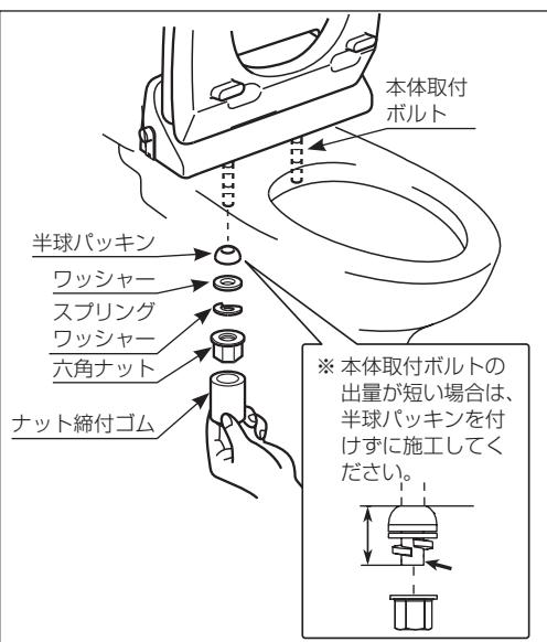
※ 便座が便器の取付穴にうまく入らない場合は、本体取付ボルトを抜いてから回転させ、取付穴の間隔と合うように調節してください。
