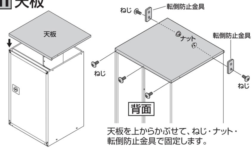
天板を上からかぶせて、ねじ・ナット・転倒防止金具で固定します。
