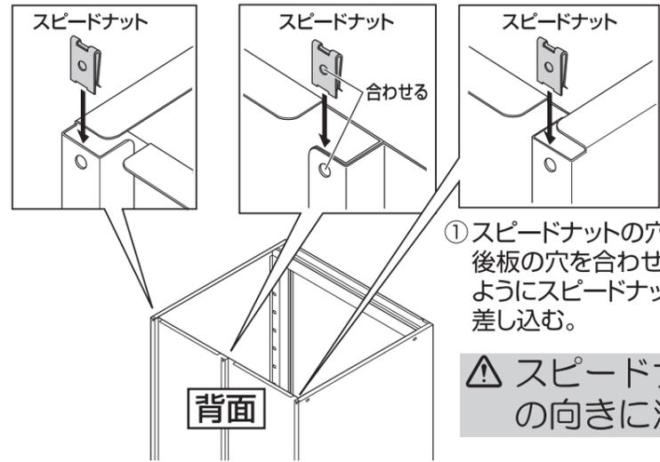
① スピードナットの穴と後板の穴を合わせるようにスピードナットを差し込む。
