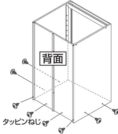
③ タッピンねじで後板、側板と底板を(仮止め)します。
