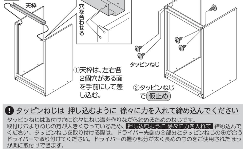
**!** タッピンねじは 押し込むように 徐々に力を入れて締め込んでください。タッピンねじは取付け穴に徐々にねじ溝を作りながら締めるためのねじです。取付け穴よりねじの方が大きくなっているため、押し込むように 徐々に力を入れて 締め込んでください。タッピンねじを取り付ける際は、ドライバー先端の⊕部分とタッピンねじの⊕が合うドライバーで取り付けてください。ドライバーの握り部分が太く長めのもをご使用されたほうが楽に取り付けできます。
