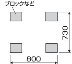
平らでない地面に設置する場合は、ブロックなどを四隅に高さを揃えて置いてから本体を設置してください。また、舗装された場所に設置する際もブロックなどで底上げして風通しを良くすると底板部のさびを防げます。ブロックは最寄りのホームセンターなどでお買い求めください。
