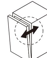
②の前後調整ネジをドライバーでまわしながら調整します。
