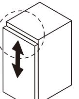
①の上下調整ネジをドライバーでまわしながら調整します。(1枚の扉には、スライド丁番が2か所ついていますので、交互にネジをまわして調整してください。)
