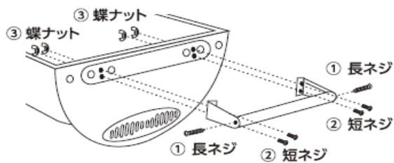
3. 前脚を本体のハンドル側に、車輪付きの後脚を反対側に、⑥長蝶ネジと⑦短蝶ネジで取り付けます。
