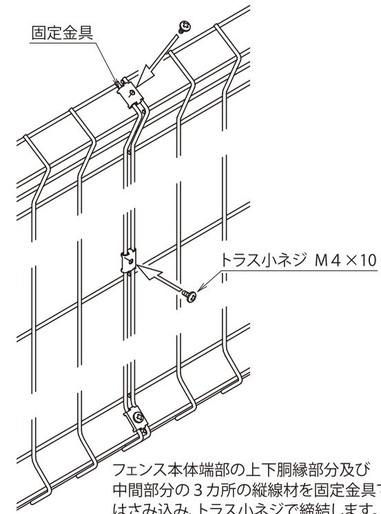
フェンス本体端部の上下胴縁部分及び中間部分の3カ所の縦線材を固定金具ではさみ込み、トラス小ネジで締結します。
