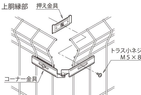
コーナー部は、上胴縁の下側と下胴縁の上側をコーナー金具と押え金具でジョイントします。
