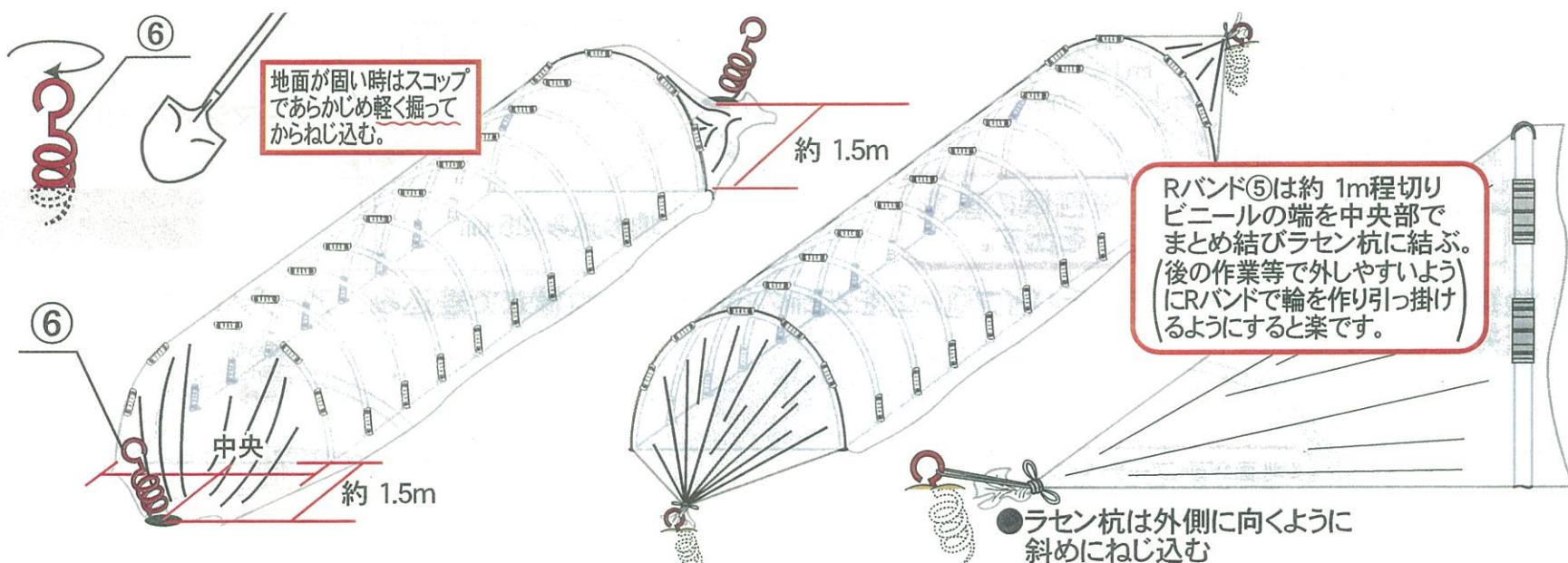
⑥ プラ杭⑦をアーチパイプとアーチパイプの間に打ち込み R バンド⑤を使用しビニールを固定する。
