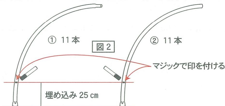
② 地面の印を付けた位置に、アーチパイプ①・②を25cmの印を付けた位置まで差込み、アーチパイプ①・②の天井部を差込む。
