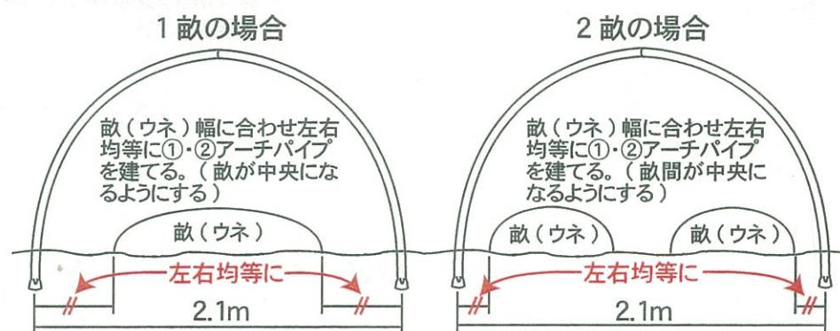
●設置場所に、間口 2.1m と奥行き方向に 1m 間隔で印をし(図 1)、アーチパイプ①・②に埋め込みの部の印(図 2)を付ける。
