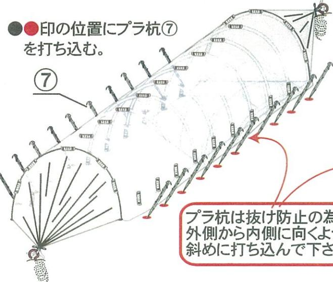
Rバンドは約 4.5m の長さでカットして左右のプラ杭に結び付ける。
