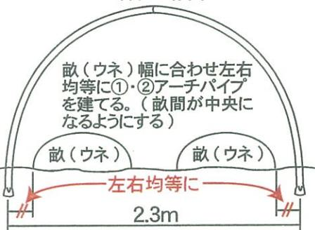
●設置場所に、間口 2.3m と奥行き方向に 1m 間隔で印をし(図 1)、アーチパイプ①・②に埋め込みの部の印(図 2)を付ける。
