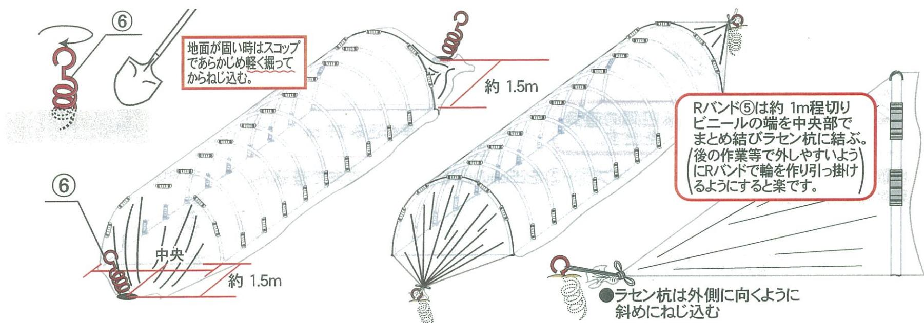
⑥ プラ杭⑦をアーチパイプとアーチパイプの間に打ち込み R バンド⑤を使用しビニールを固定する。
