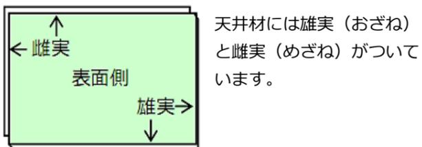
雌実(めざね)に雄実(おざね)を差し込んで施工していきます。雄実はステープルで天井地下材に留め付けていきます。
