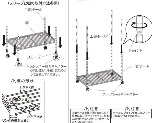
3 上部ボルトのジョイントを下部ボルトにねじ込みます。
