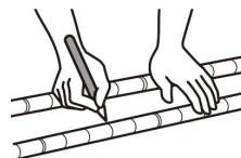
2 印をつけたポールの溝にスリーブ内側の凸部を合わせ、ポールをはさむようにしてセットしてください。
