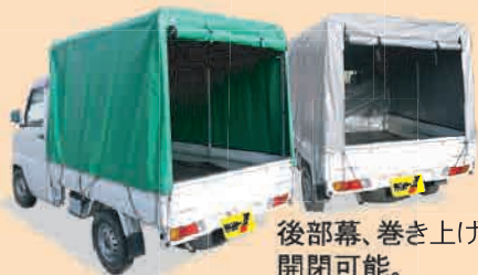
幌のかぶりを、軽トラ各種のキャビンの高さに合わせて取り付けられます(骨組高さ調整可能)。さらに、雨に強くなりました。
