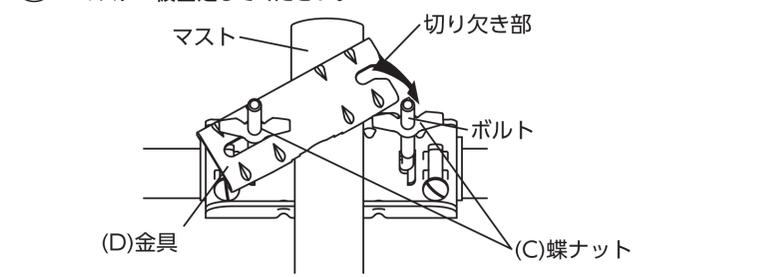
⑦ アンテナの方向と高さを調整します。調整後、⑥で仮締めした(C)蝶ナットをしっかりと締め付けて、マストへ固定してください。
