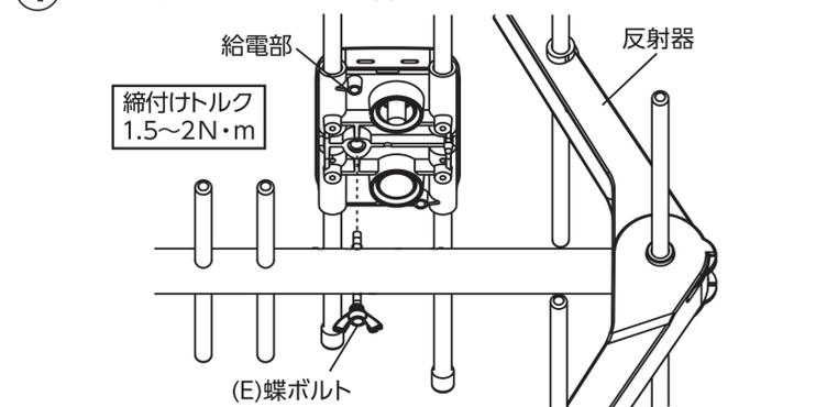
⑤ 先端にF形接栓を加工した同軸ケーブルを、F形座へまっすぐに挿入し接続ナットを締め付けて固定してください。
