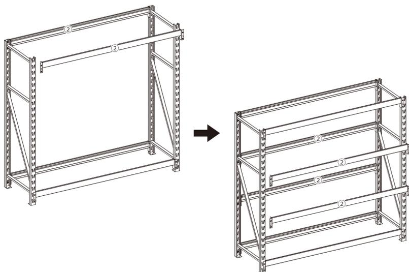
**3** ②シェルフビームの中央に④ストッパーを⑥ボルトと⑦ナットで取り付けます。(⊕ドライバー・脚立使用)
