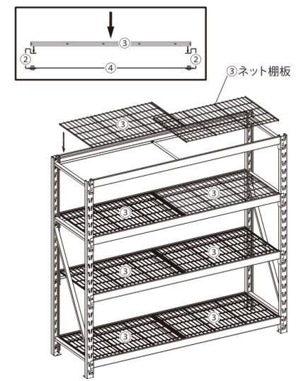
**5** ⑤抜け防止ピンを16箇所に取り付け完成です。(脚立使用) 各部のボルトをしっかり締めなおし、グラつきやガタつきがないことを確認してから、使用してください。
