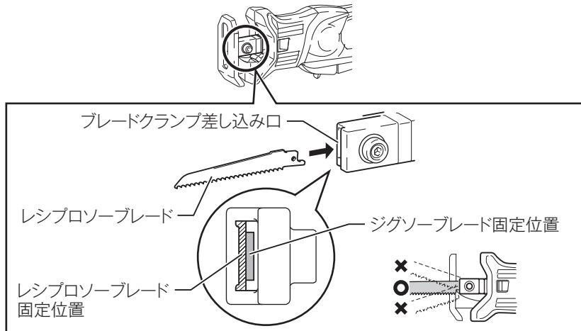
※作業中にブレードが落ちないことを確認するために、軽く引っ張って確認してください。
