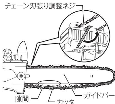
7. チェーン刃の張りを調整後、ガイドバー先端部を矢印側に上げた状態で六角穴付ボルトを六角棒スパナ5でしっかり締めます。
