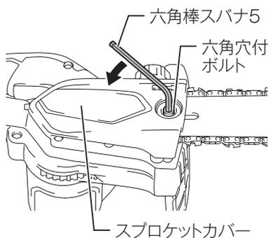
3. ガイドバー先端部を矢印側に上げた状態にします。
