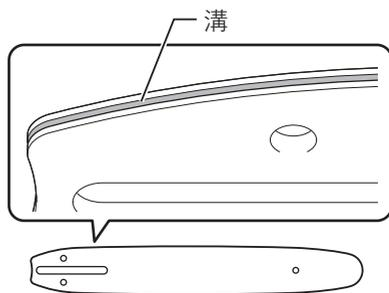
7. ガイドバー外周の溝にチェーン刃を挿し込みます。ガイドバーの後端とチェーン刃の間に空間があくようにします。
