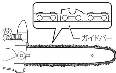
9. ガイドバーの中央付近でチェーン刃を軽く持ち上げたときに、チェーン刃のカッタ底面とガイドバーの間に隙間 (1 ~ 2 mm) があること。
