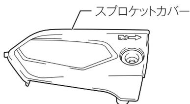
13. スプロケットカバーの突起部を本製品の穴に挿し込んだ後、ピンとピン穴を合わせて取り付けます。
