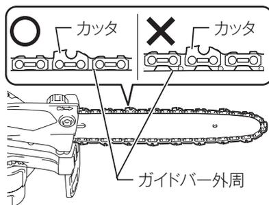
5. チェーン刃張り調整ネジを右に回すとチェーン刃が張り、チェーン刃のカッタとガイドバーの間の隙間が少なくなります。
