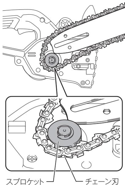
11. その状態のままガイドバーの丸穴をテンションスライドへ、長穴を2本のボルトに合わせます。
