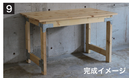
5 で固定した木材 E と木枠をアングル A23 で固定する。(4 カ所)
