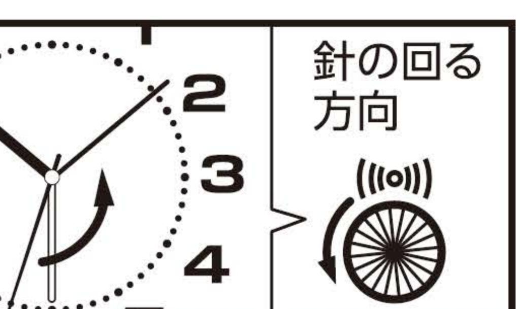
上図の③アラーム時刻セットツマミを回して、アラームが鳴る時に合わせます。
