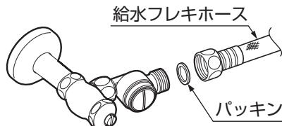
※給水フレキホースが折れないように接続方向を調整してください。
