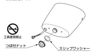
⑥陶器タンク外側から取付ボルトを通し、締め込む。 ※樹脂タンクがガタつかないように手締めで確実に 固定してください。
