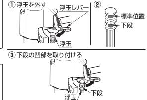
⑤フックを解除し、ボールタップのタンク 取付位置を上段に変更する。
