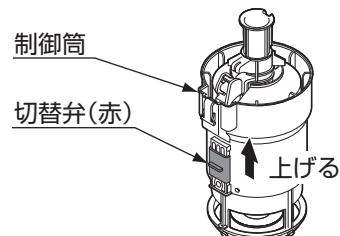
⑧制御筒を時計回りに回して取り付ける。
