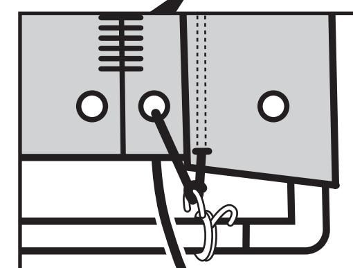
※前面のみ、前幕の裾部分のハトメも絞りロープで結び止めます。
