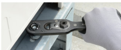
ギヤをロックしてオフセットアダプターで手締めができる! (AOA-19GL)
