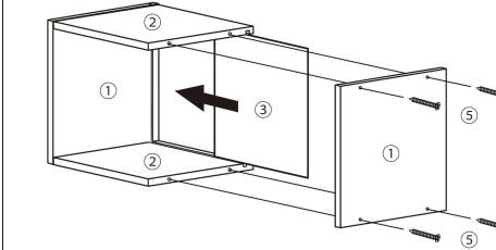
3 各ネジをしっかりと締めなおし、グラつきやガタつきがない事を確認してから、ネジ穴とダボ穴に⑥カバーシールを貼ります。
