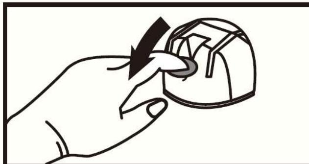
② 設置面に本体を押し付けて、レバーを下ろし吸盤を固定してください。本体が設置面に吸着していることを確認してください。
