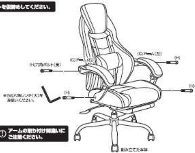
8 組み立てた本体にボルト締しを取り付けます。
