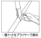
込み固定します。 注1 注 2 注1 ①車輪支え用パイプは、赤点線のように、 平行を保ち、取り付けてください。
