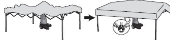
△ 必ず両手でフレーム中央部分(ワンアクションシステム)がしっかりと固定されていることを確認してください。
