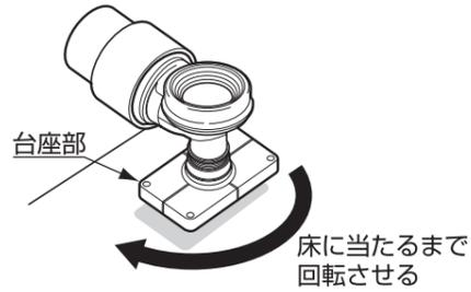
⑤台座が壁に平行になるように調整し、排水ソケット中心線をけがく。
