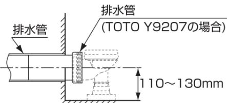
③台座を縮めた状態で、排水管に排水ソケットを差し込む。
