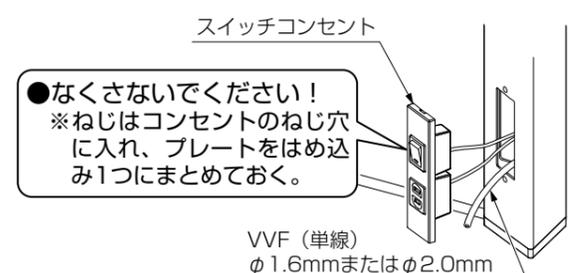
⑩スイッチバー切欠き部を引掛け金具へ落とし込む。
