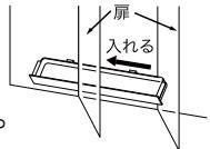
②収納トレイを水平に倒し、背面のツメを本体側の穴にしっかり差し込む。
