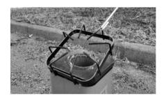
② 吊り棒を燃焼筒の大きいナットの穴に差し込み、反対側 の小さいナットにねじ込んで上に引き上げてください。
