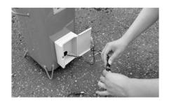
⑤ スイッチケーブルをUSB電源を接続してください。(写真ではモバイルバッテリーを接続しています。)
