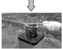
③ 灰を燃焼筒から鉄バケツなどの耐火性の容器に移し替えてください。
