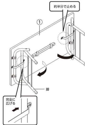
**2** 必ず下段パイプに引っ掛けます。棚が落下してケガや破損の原因になります。
