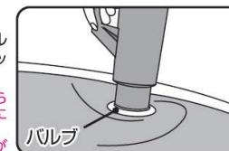
バルブに直接掃除機のノズルを垂直にあてて掃除機のスイッチを入れて吸引してください。
