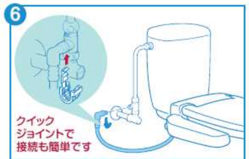
6 給水ホースをつなぎます。 止水栓とシャワートイレを、 付属の「本体給水ホース」でつなぎます。
