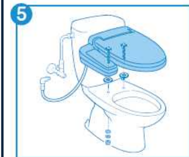
5 シャワートイレを取り付けます。 シャワートイレを取り付けます。
