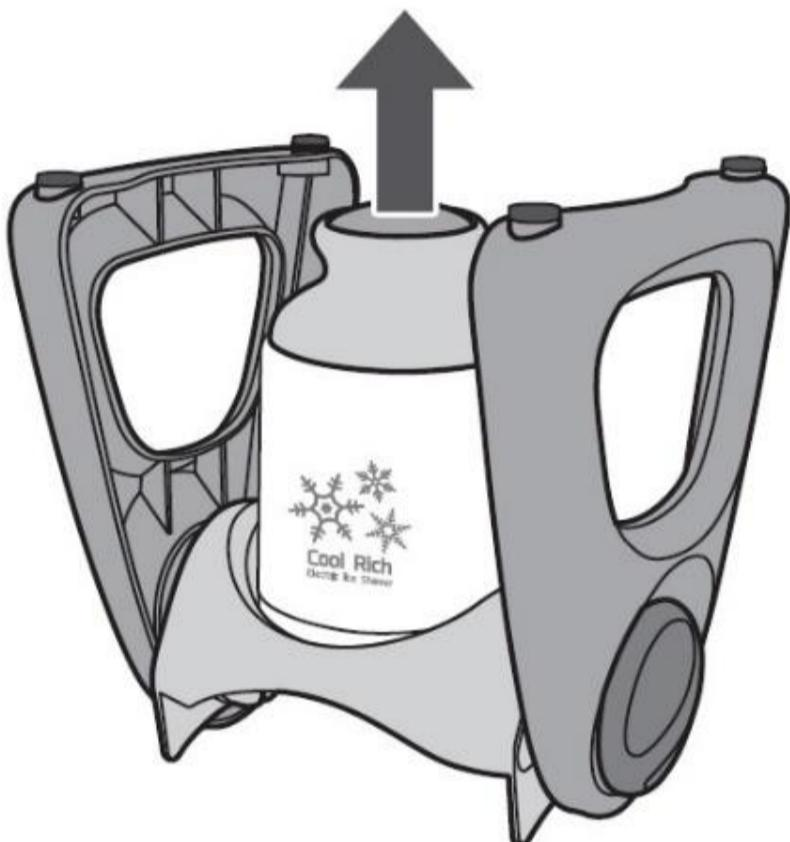
②固定ネジを〈はずす〉の方向に回して引き抜き脚部を取りはずします。
