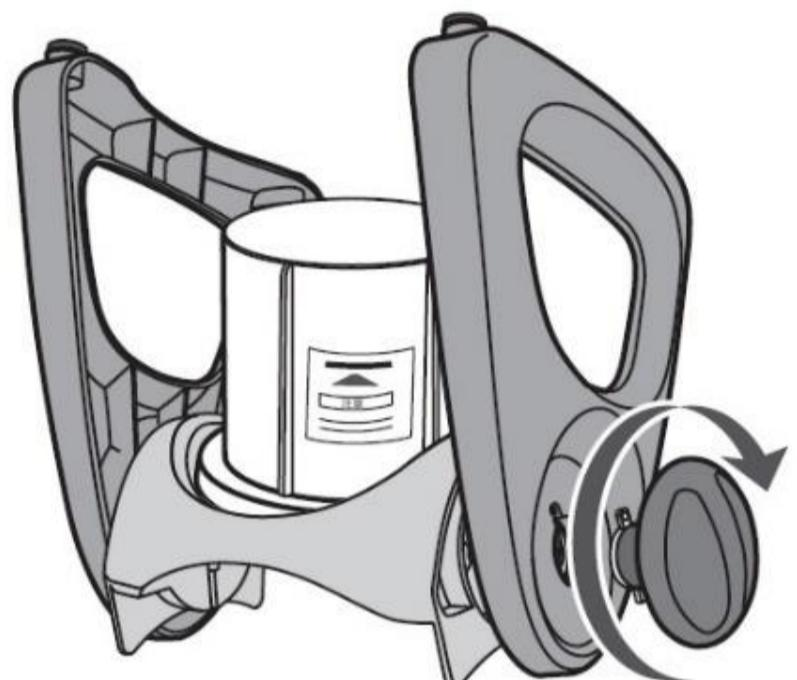
③図のように脚部をつけ直し、固定ネジを差し込み〈しめる〉の方向に回し、脚部をしっかりと固定してください。
