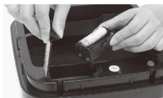
⑤上図のようにバッテリーカバーの接点を合わせてセットしてください。
