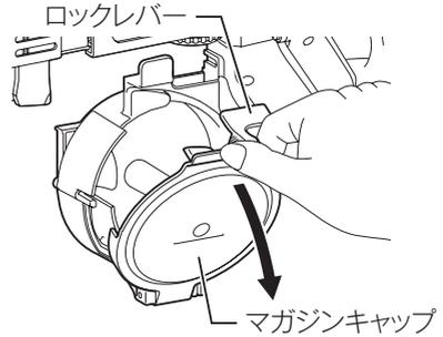
2. コイルタイプの連結ネジを図のように巻いた状態で、マガジンに入れます。
