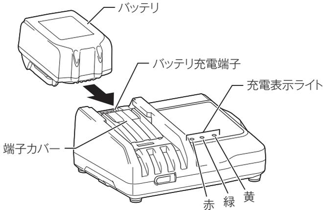
1. 充電器の電源プラグを 100 V の電源コンセントに挿し込みます。
