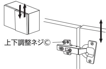
ねじ③をゆるめて扉を上下に調整した後、調整ねじ③を締め直します。
