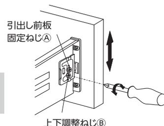
2. 上下調整ねじ<sup>Ⓑ</sup>で引出し前板の位置を調整する。
