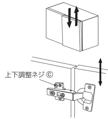
ねじ③をゆるめて扉を上下に調整した後、調整ねじ③を締め直します。
