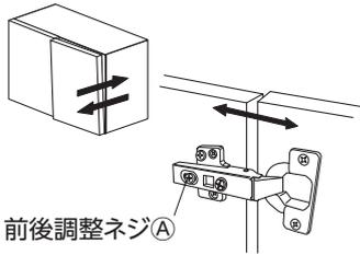
ねじ①をゆるめ、扉の前後を合わせた後、調整ねじ①を締め直します。
