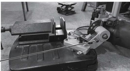
2. コンターテーブルの切り欠きの部分に刃がくめるように設置し、バイスでコンターテーブルを固定します。
