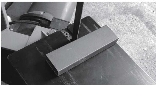
4. 材料の切断が終了したら、電源スイッチの OFF スイッチ (「O」) を押して OFF にしてからトリガロックを解除します。
