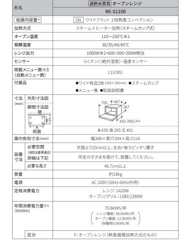
●写真はイメージです。\*総庫内容量とは、JIS規定に基づいて算出された容量です。※1 250℃での運転時間は約5分間。その後自動的に210℃に切り替わります。※2 1000Wでの連続運転時間は最大3分間 ※3 付 属のメニュー集で紹介しているメニュー数です。※4 ( )内はハンドルを含んだ数値。※5 年間消費電力量は、省エネ法・特定機器「電子レンジ」の新測定法による数値です。(区分法も同法に基づいています。) ●実際にお 使いになるときの消費電力量は、使用回数や使用時間、食品の量、周囲温度などによって変化しますので、あくまで目安としてご覧ください。
