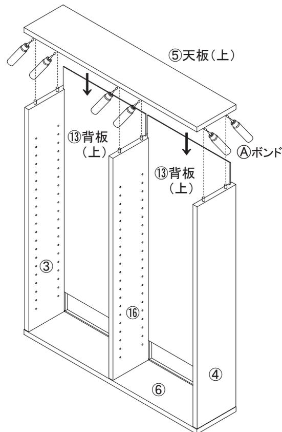
**工程 8 (上段)** 背面に横揺防止部品を取り付けます。
