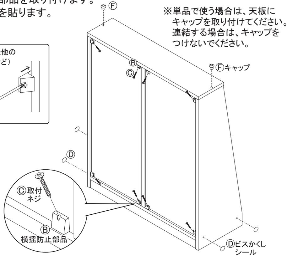
**工程 6 (上段)** 地板(上)に、左右側板(上)・仕切板を取り付けます。
