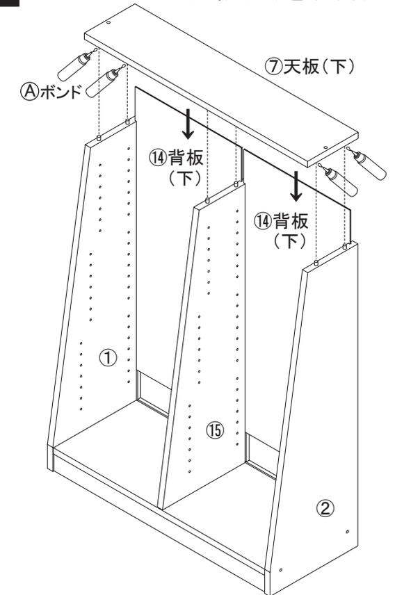
**工程 5 (下段)** 背面に横揺防止部品を取り付けます。
