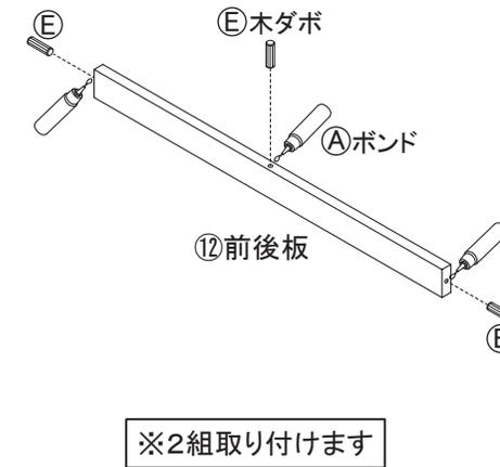
**工程 1** 地板(下)に、前後板を(下段)に取り付けます。
