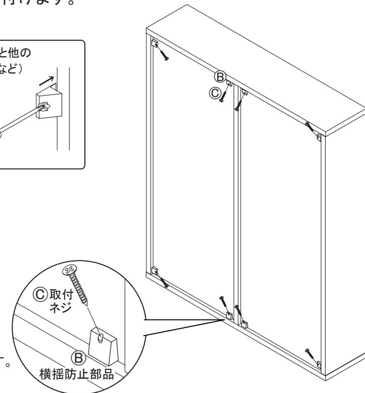
工程 9 【下段組立品】と、【上段組立品】を連結します。
