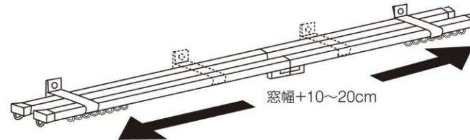
(2)レールの長さに合わせてブラケットの取り付け位置を調節してください。両端のブラケットはレールの端から5~10cm位の位置に固定し、残りのブラケットを35~60cmに1個の間隔で固定してください。またブラケットは等間隔に取り付けるのが最適です。
